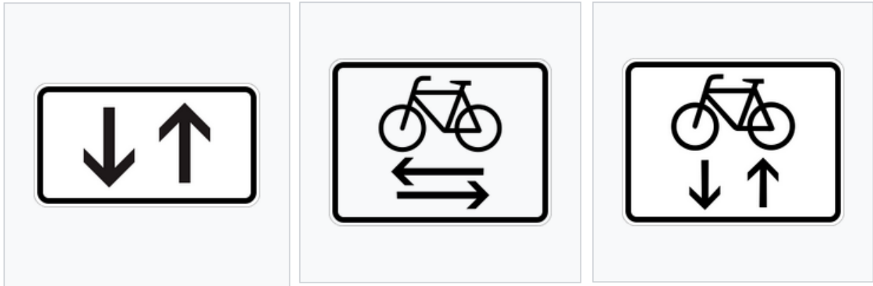
Abbildung 28: Zusatzzeichen zur Kennzeichnung von Zweirichtungsradwegen von links nach rechts: 1000-31 (empfohlen), 1000-32 (empfohlen, an Kreuzungen über vorfahrtsregelnden Zeichen verpflichtend); 1000-33 (nicht mehr gültig)
