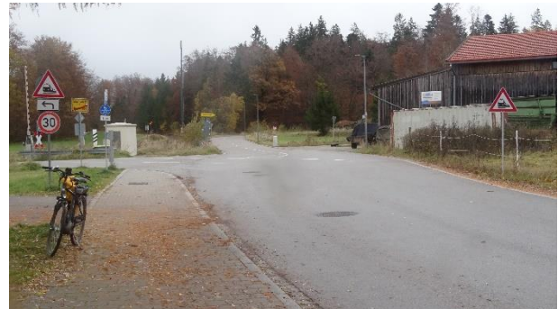
Abbildung 26: fehlende Überleitung zwischen baulichem Radweg und Führung auf der Fahrbahn (MB 6; links) und fehlende Überleitung ohne Rückenschutz am Brunnenweg (rechts)
